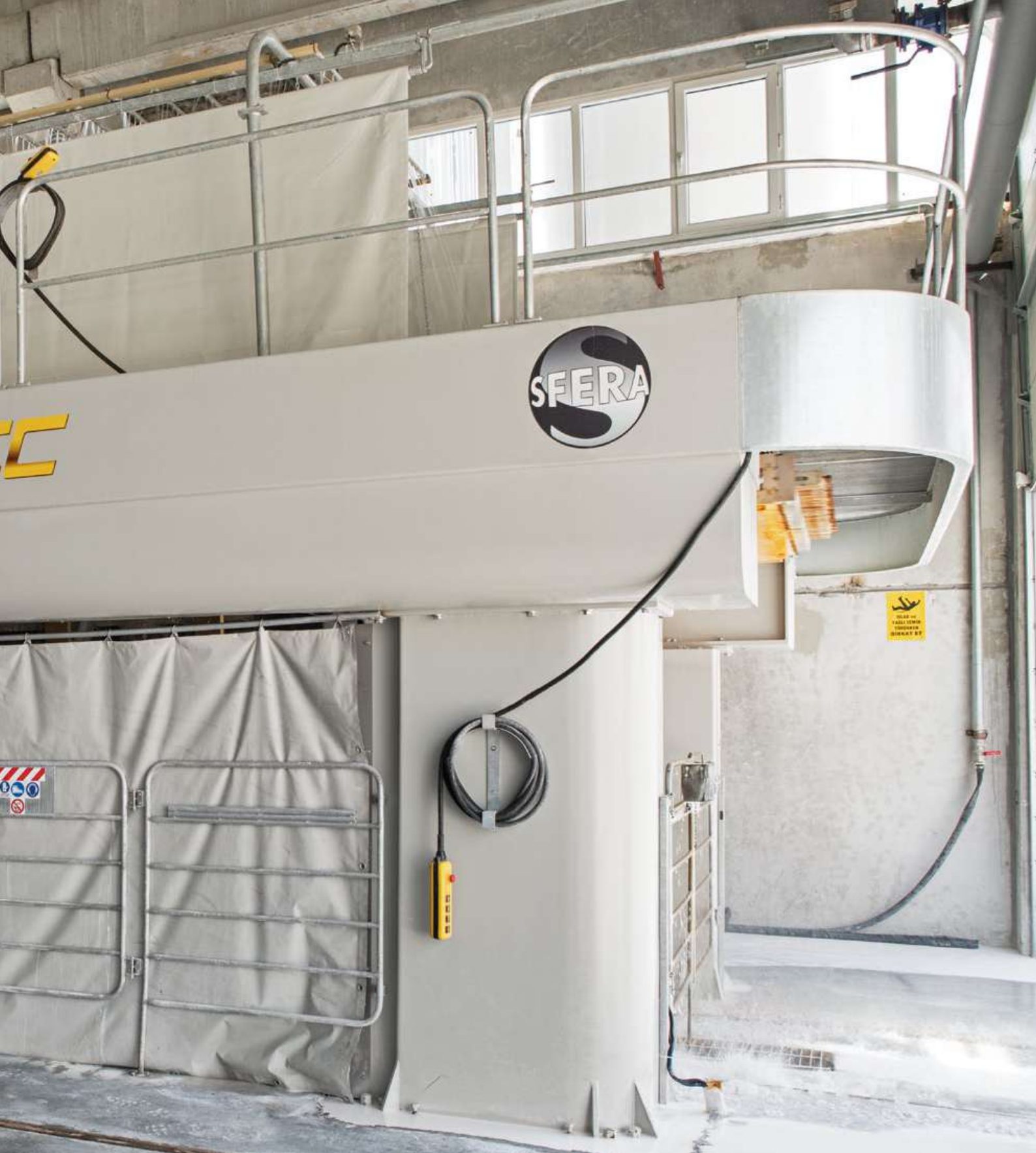
Vista d'insieme di un telaio SFERA durante la fase di taglio. Overall view of a SFERA gangsaw during the cutting phase.
