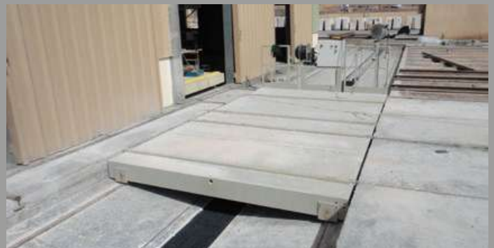
Carro trasbordatore motorizzato a due piazze. Two-place motorized transfer trolley.
