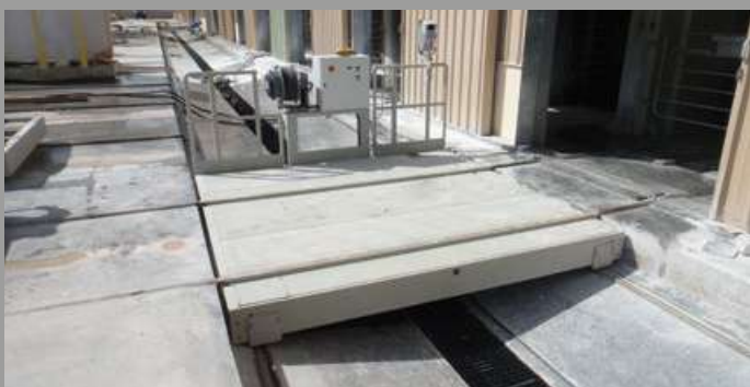
Carro trasbordatore motorizzato a una piazza. - One-place motorized transfer trolley.
