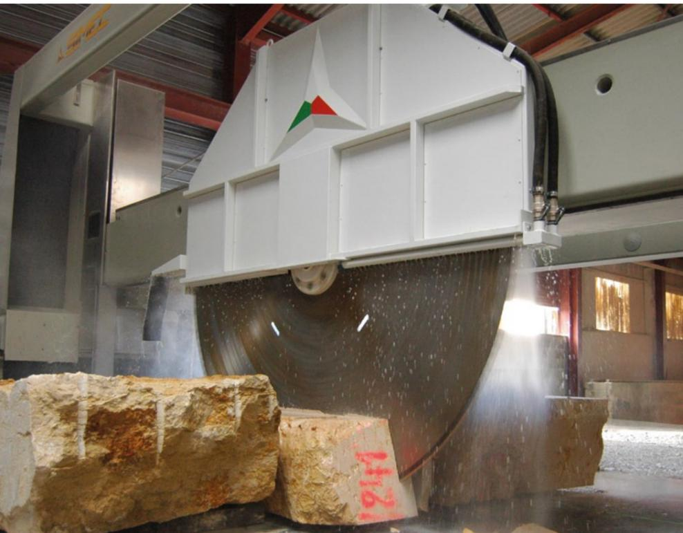
Sopra: le tagliatrici MAXI RX MOB sono configurate con vie di corsa molto lunghe che offrono la possibilità di eseguire, in completa autonomia, tagli programmati per cicli di diverse ore.
