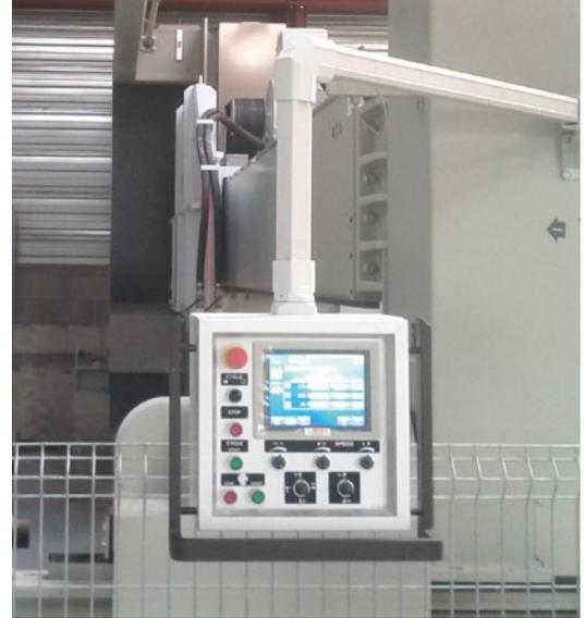
A lato, particolare del pannello touch screen a colori che permette la programmazione dei tagli in sequenza, di tutti i blocchi collocati nell'area di lavoro della macchina.
