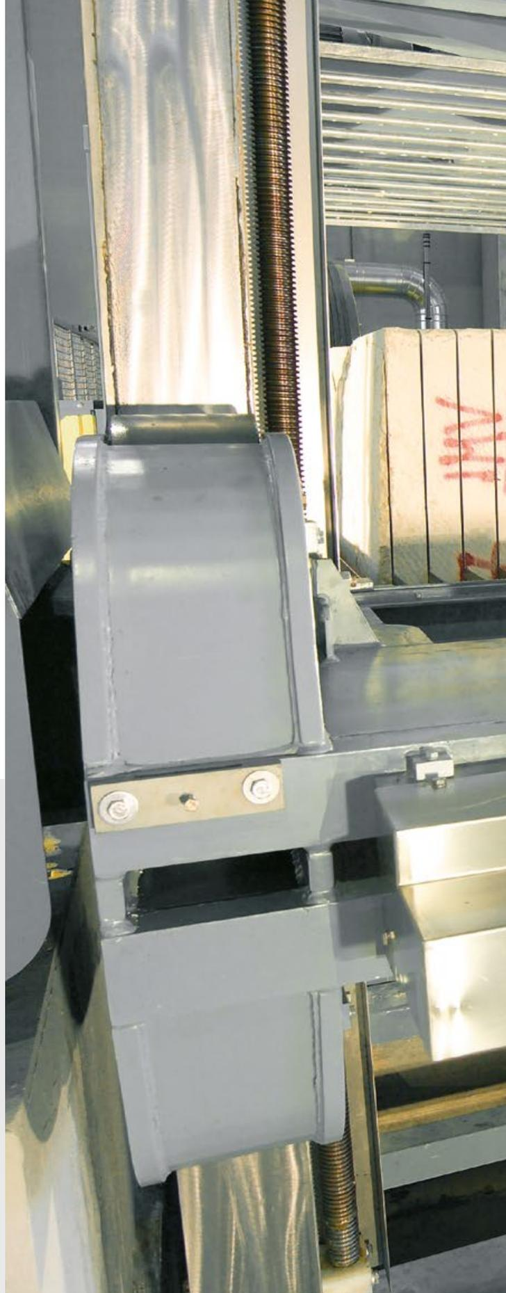
Sopra: particolare dei tenditori idraulici, visibili grazie ad un effetto di trasparenza delle protezioni in acciaio inossidabile. Nella stessa immagine si può osservare il nuovo sistema di guida del quadro portalame presentato nelle pagine successive.
