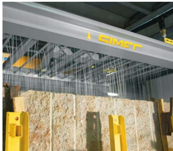
Sopra: particolare del sistema di distribuzione pioggia fornito con i telai serie M
