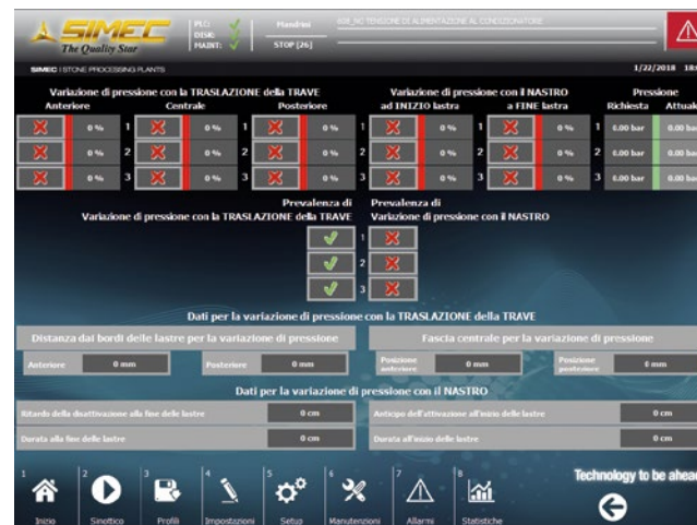
Particolare dell'interfaccia di gestione delle valvole proporzionali Particolare dell'interfaccia di gestione delle valvole proporzionali
