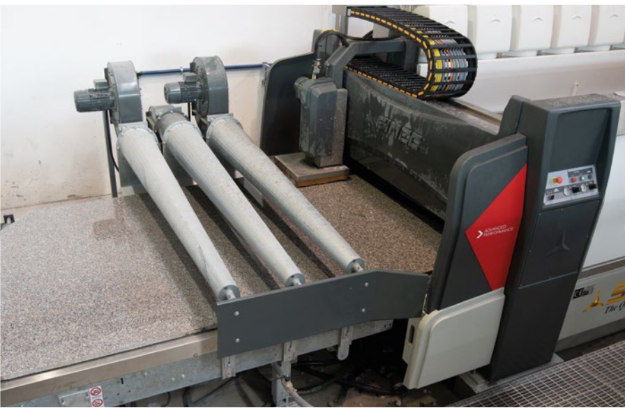
In alto: speciale mandrino per la pulizia delle lastre a fine lucidatura, che esegue automaticamente il passaggio su ogni lastra in transito.
