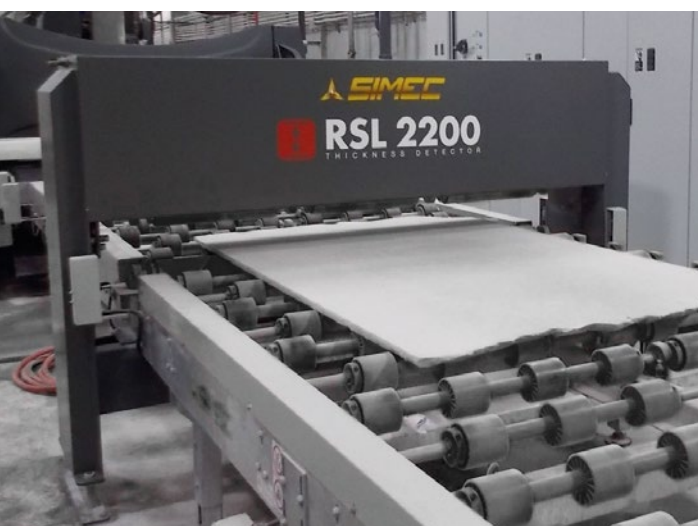
Sopra: dispositivo di rilevamento della morfologia della superficie lastra, mod. RSL 2200.
