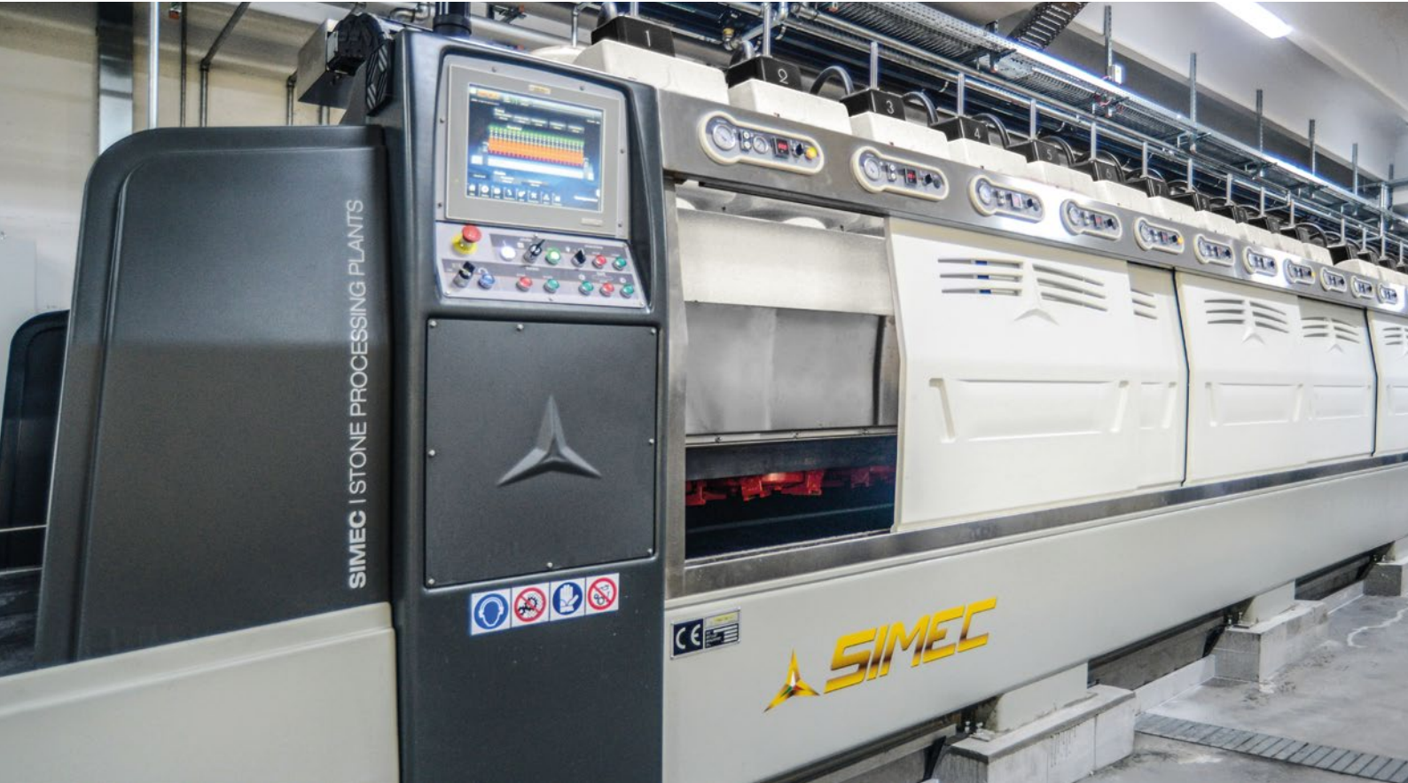
Sopra: particolare di una linea di lucidatura ad altissime prestazioni, equipaggiata con TESTAROSSA modello HP 6.
