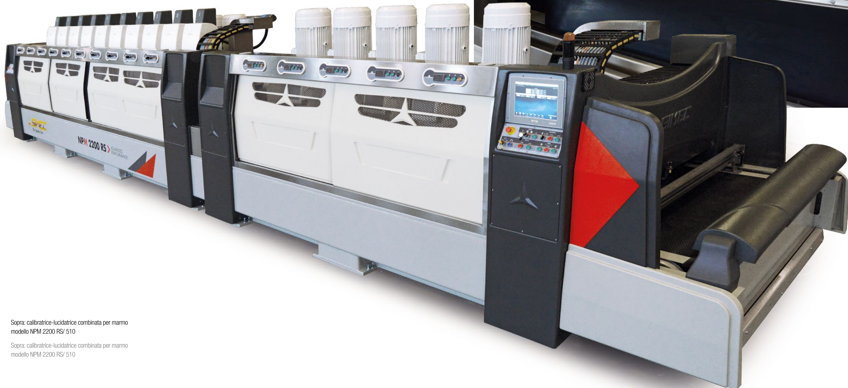
Sopra: Particolare dei mandrini calibratori installati su ponte mobile, che equipaggiano la macchina.
