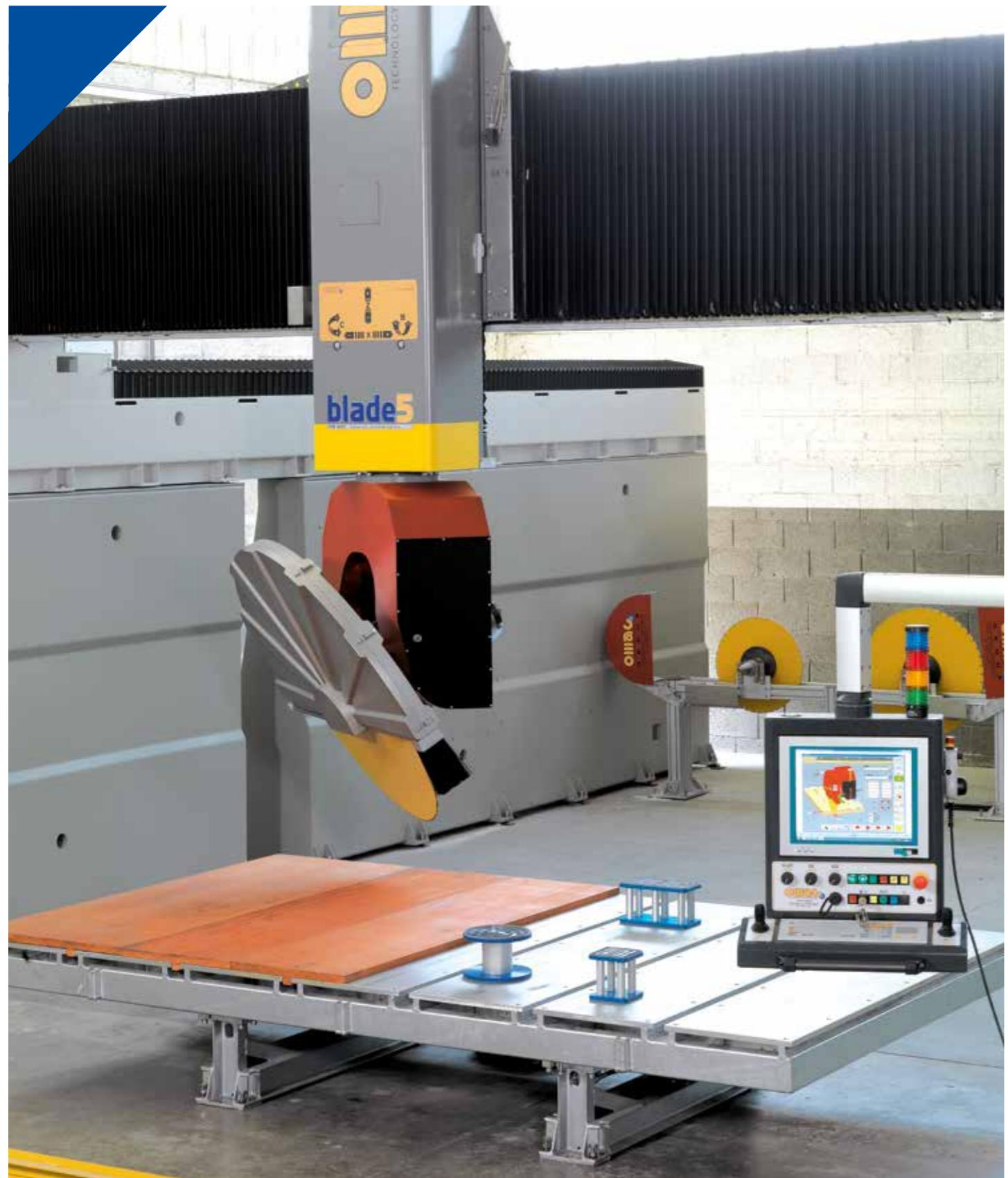
Tête inclinable et rotative pouvant recevoir des disque de Ø 625 ÷ 1.600 mm selon les configurations
