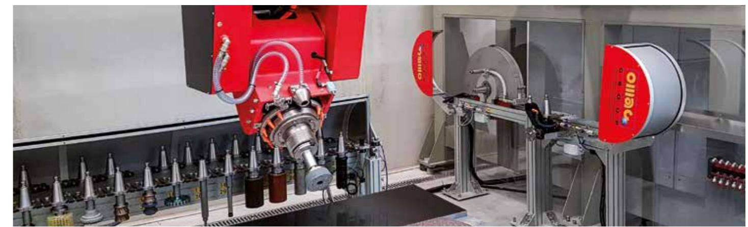
Changement de disque automatique jusqu'au diam. 1200 mm
