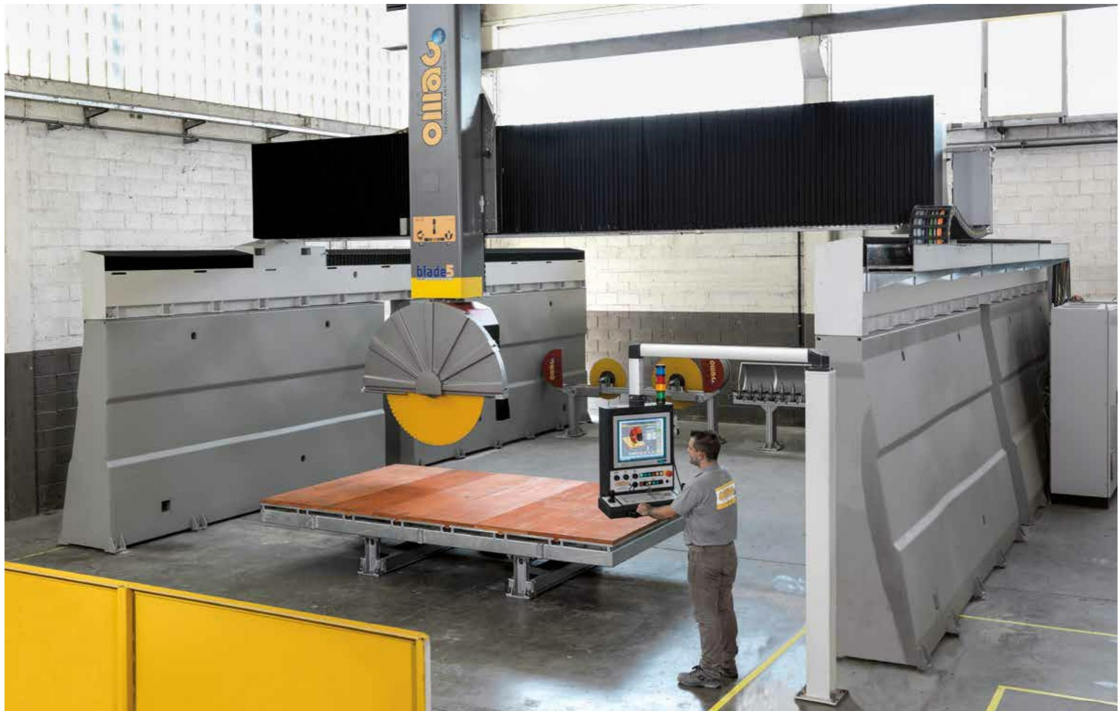
Una macchina BLADE significa tecnologia unica, precisione e affidabilità. Questo è un centro di lavoro a controllo numerico, progettato per lavorare con grandi dischi e utensili di tutte le misure, marmo, pietra o granito.
