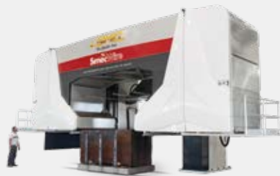
TAGLIO DEI BLOCCHI BLOCK SAWING
