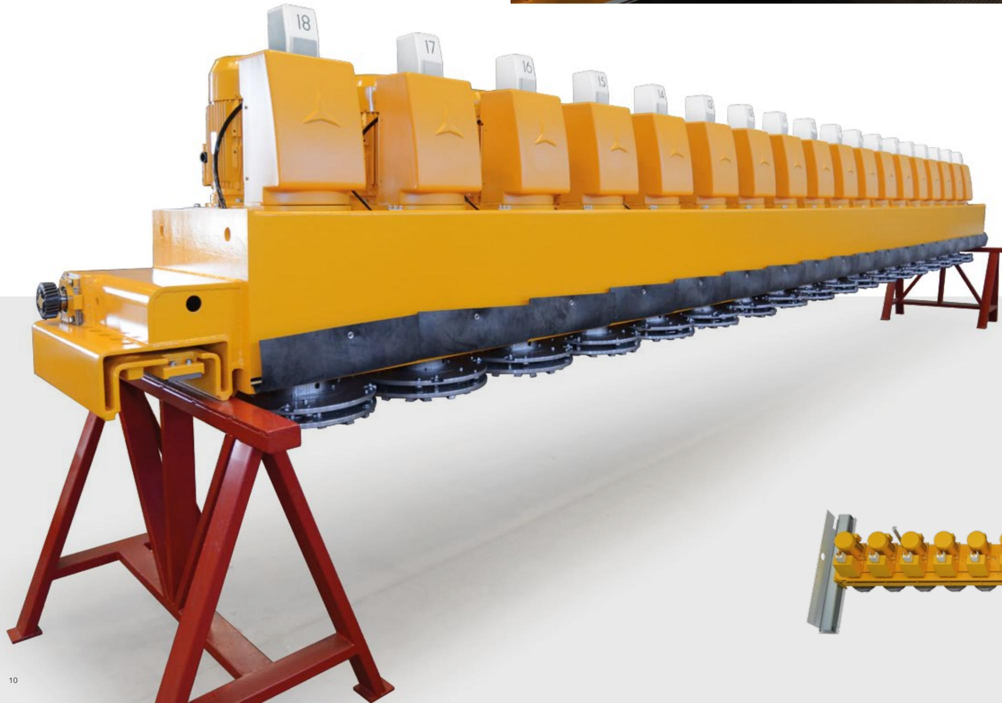
Schema della struttura di un ponte portamandrini. I fori per l'inserimento dei mandrini sono realizzati al centro della trave per garantire una perfetta distribuzione delle masse in movimento.
