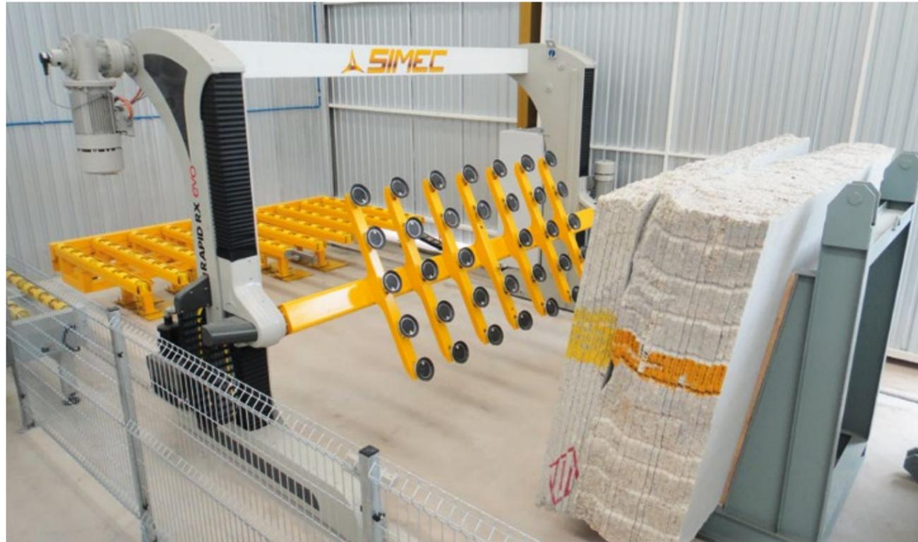
I Robot sono equipaggiati con un numero elevato di ventose (34 per granito e 53 per marmo) in modo da movimentare materiali molto sottili o particolarmente difettosi. I caricatori/scaricatori RAPID sono disponibili in versione standard con portata di 1200 kg o 'grossi spessori' con portata di 2000 kg.
