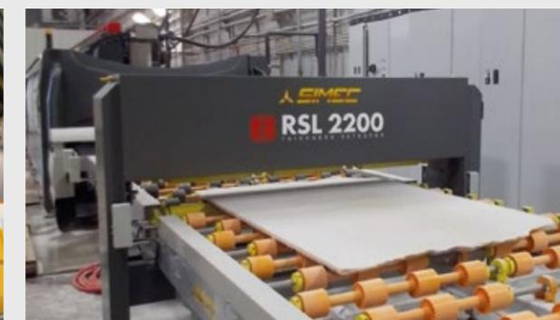
Sopra: dispositivo di rilevamento della morfologia della superficie lastra, mod. RSL 2200.
