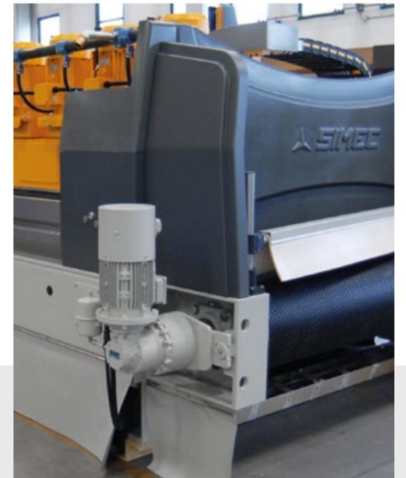
Sopra: particolare del sistema di trasmissione del nastro trasportatore.
