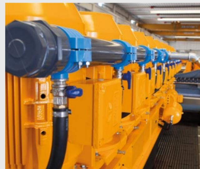
Sotto: particolare del sistema di distribuzione dell'acqua tramite una tubazione in PVC di grosso spessore.
