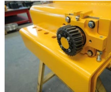
Particolare del sistema di trasmissione a pignone su cremagliera elicoidale e pattini a rulli in bagno d'olio protetti da carter a labirinto in acciaio inox.
