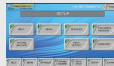
Dalla schermata principale è possibile accedere a tutti i parametri di lavoro e controllo della macchina.
