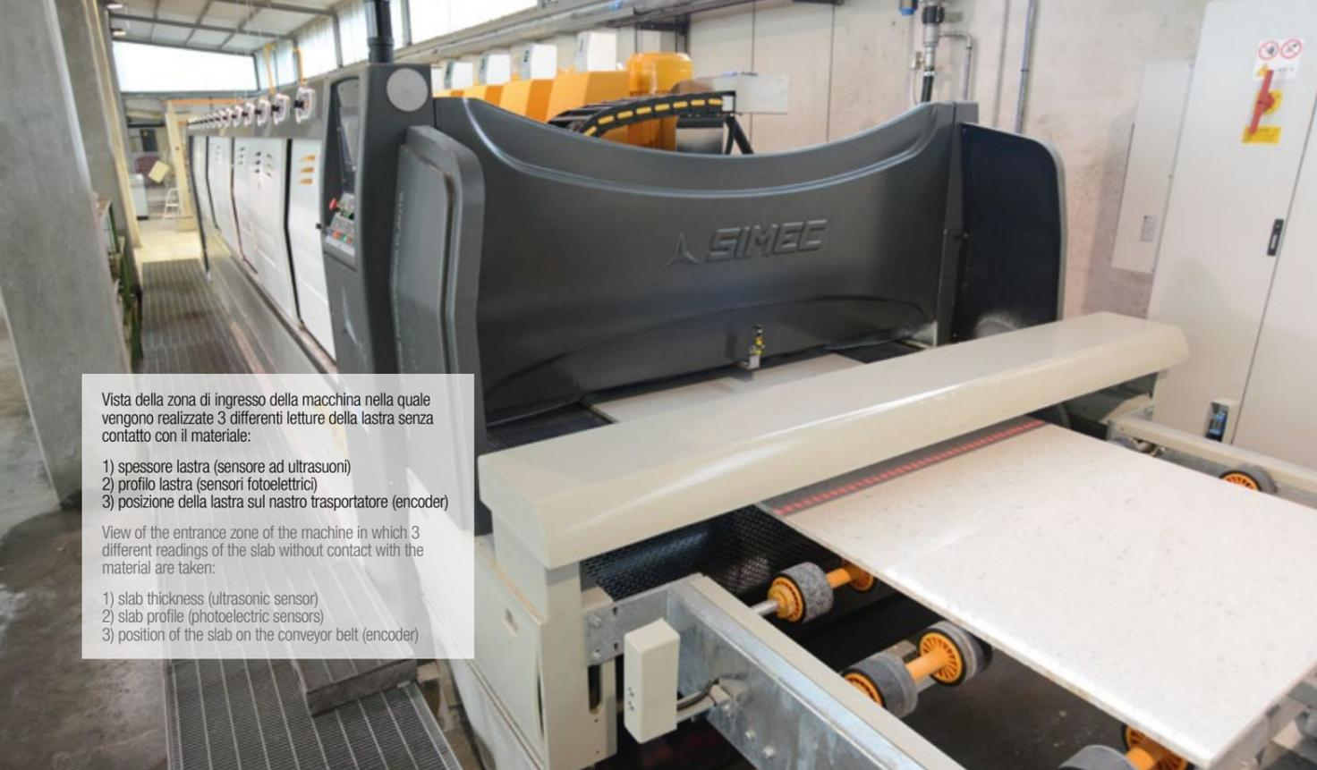
Vista della zona di ingresso della macchina nella quale vengono realizzate 3 differenti letture della lastra senza contatto con il materiale:
