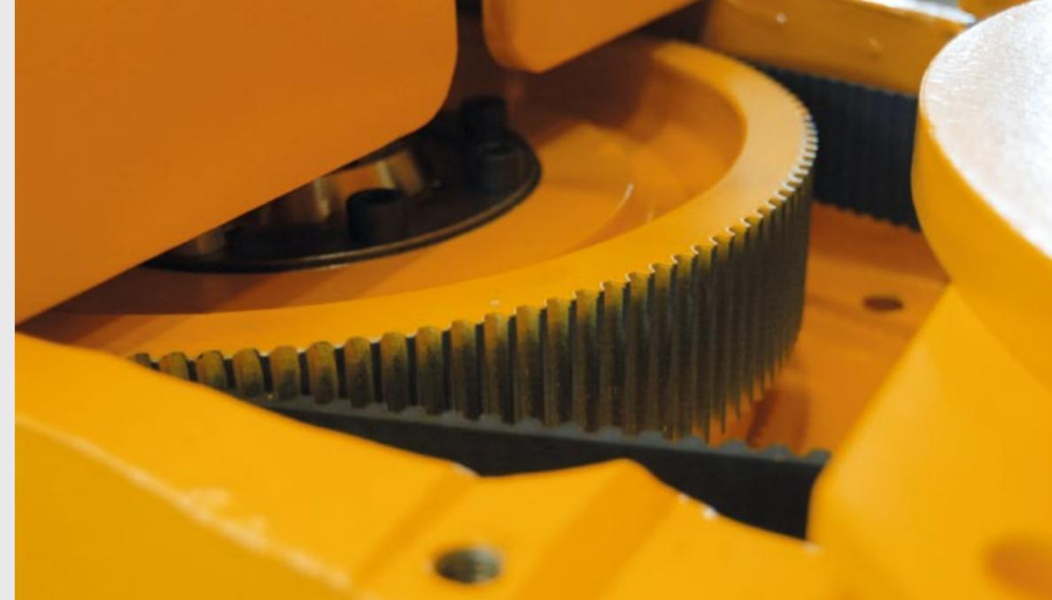
Ogni mandrino dispone di un sistema di trasmissione a cinghia dentata che rende impossibile lo slittamento o l'allentamento della stessa, anche sotto sforzo. Questo componente vanta caratteristiche di robustezza eccezionali che rendono rarissima la sua manutenzione. I nuovi mandrini possono ospitare 2 differenti motorizzazioni: 11 kW e 15 kW.
