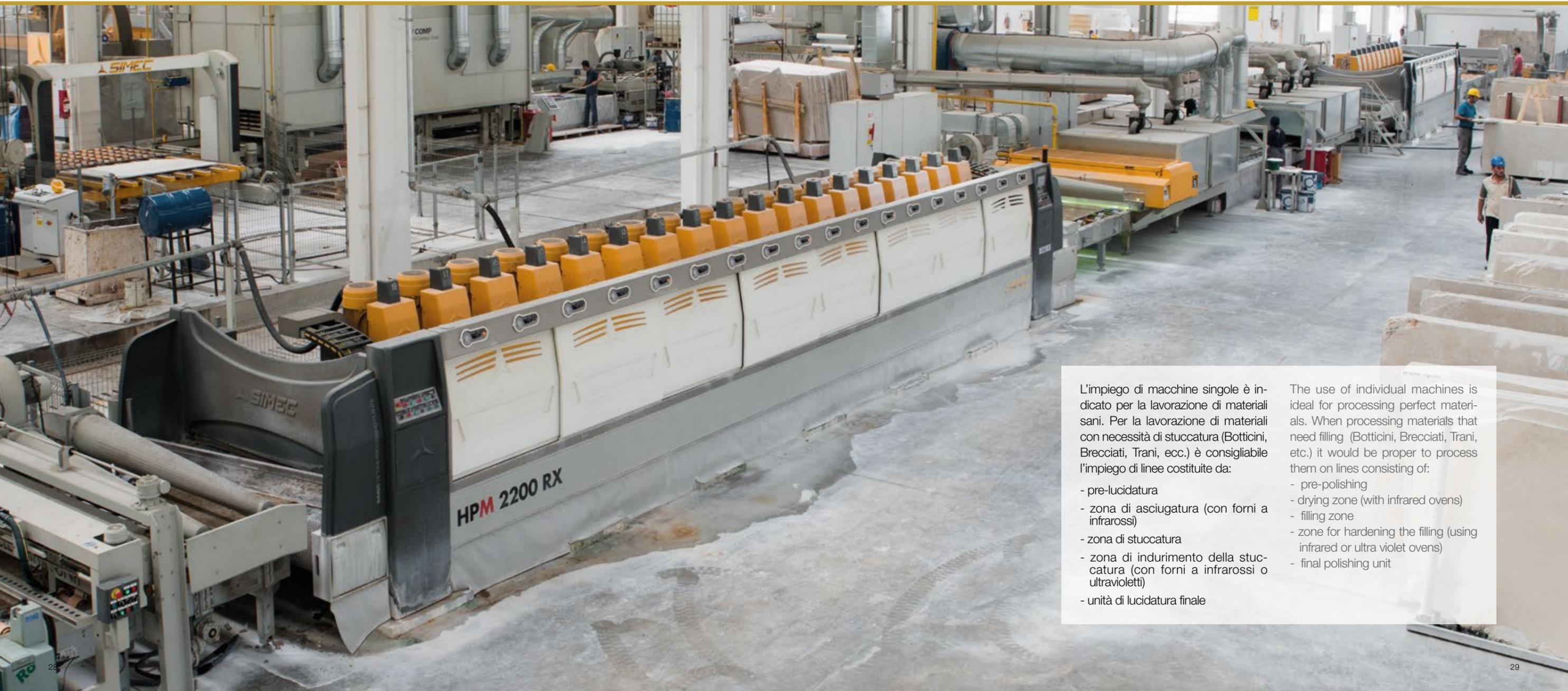
L'impiego di macchine singole è indicato per la lavorazione di materiali sani. Per la lavorazione di materiali con necessità di stuccatura (Botticini, Brecciatì, Trani, ecc.) è consigliabile l'impiego di linee costituite da:
