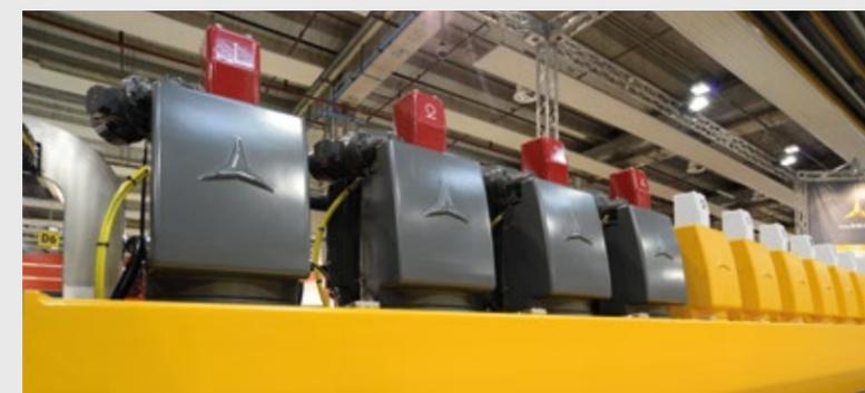
Sopra: particolare di alcuni mandrini spianatori installati nelle prime posizioni del ponte di lucidatura di una lucidatrice HPM 2200 RX, per rendere la macchina in grado di eseguire l'operazione di spianatura delle lastre.
